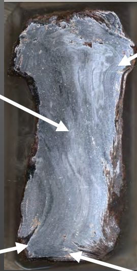
Slag stringers perpendicular to rivet shaft
